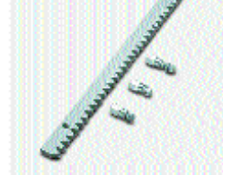
CVZ: Eisenzahnstange 30x12 Modul 4 verzinkt mit Langlöchern (1m-Stücke). Höchstbelastung 2000 Kg
